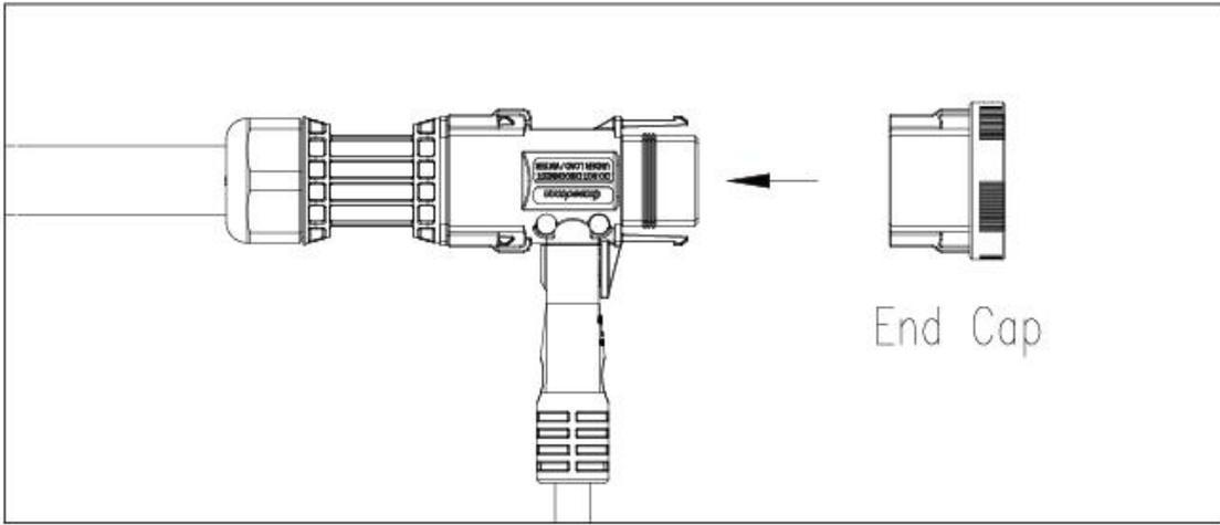
3 ) Installieren Sie das AC-Endkabel auf der anderen Seite des AC-Trunk-Kabels (angeschlossen an den Verteilerkasten)
