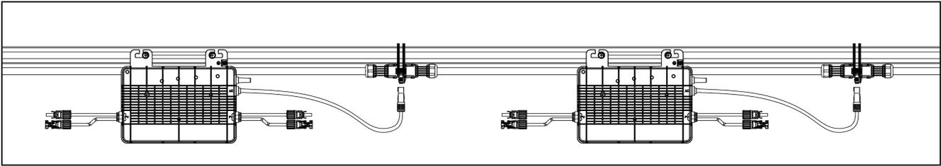
B) Schließen Sie das AC-Endkabel an den Verteilerkasten an und verbinden Sie es mit dem lokalen Netz.
